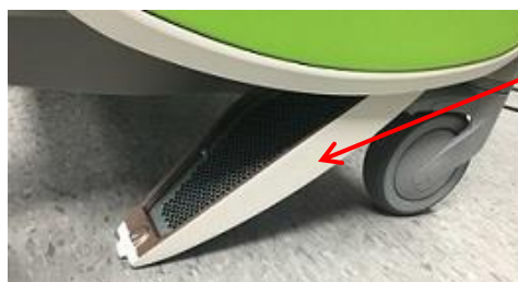
Obrázek 69: Přístup k dolnímu vzduchovému filtru
