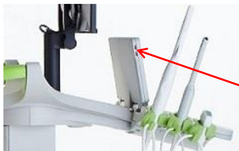
Obrázek 7: Konektory USB na levé straně dotykové obrazovky
