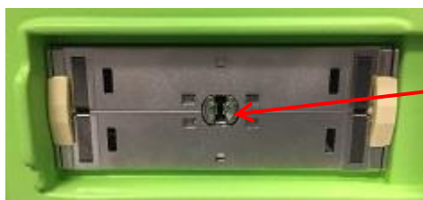
Obrázek 20: Zamykací drážka na slotu konektoru sondy
