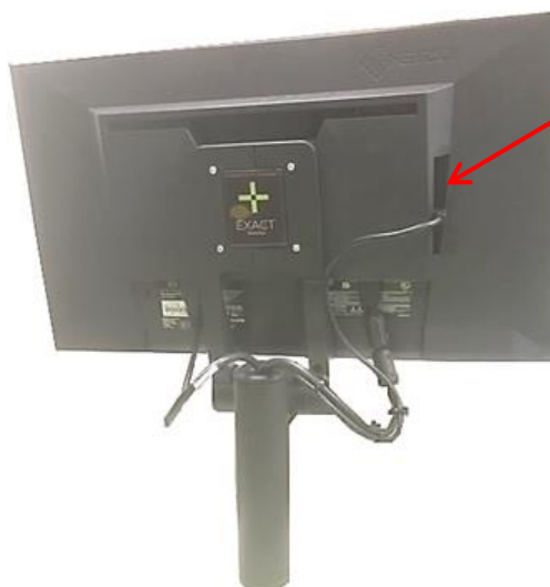
Obrázek 8: Konektory USB na zadní straně monitoru (dostupné u některých konfigurací systému ExactVu)
